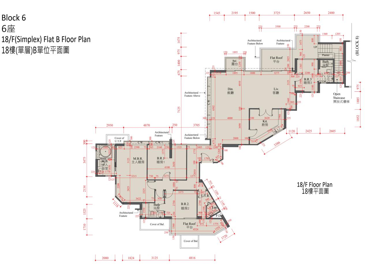
Floor-to-Floor Height (mm) : 3450 SCALE: 0M/米 5M/米 比例: 層與層之間的高度(毫米)
